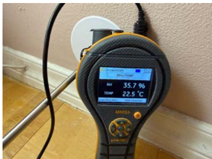
Måling av relativ luftfuktighet.
