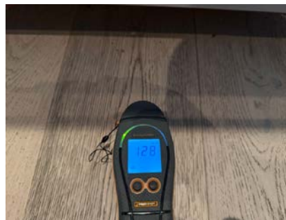
Ingen forhøyede fuktverdier ble registrert v/ utsatte områder.
