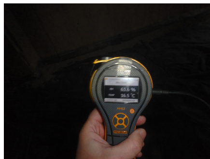
Måling av relativ luftfuktighet (RH) og temperatur i krypkjeller på besiktigelsen.
