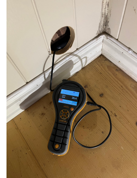
Fuktmåling i utforet vegg viste skadelig fukt.
