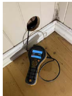
Fuktmåling i utforet vegg viste skadelig fukt.
