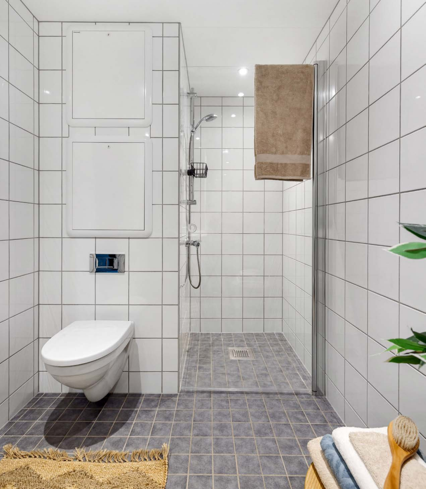
Dusjnise med dusjdør og vegghengt dujsbatteri. Veggmontert toalett.
