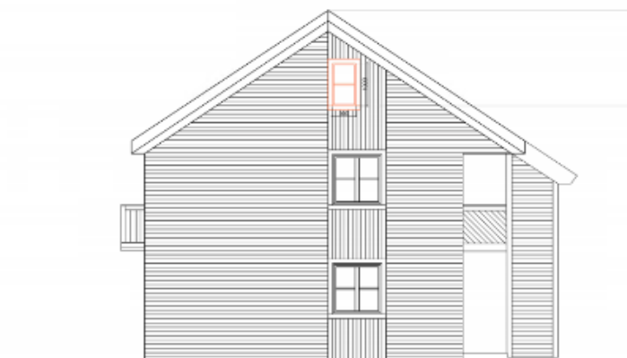
ny fasade, nytt vindu markert i rødt
