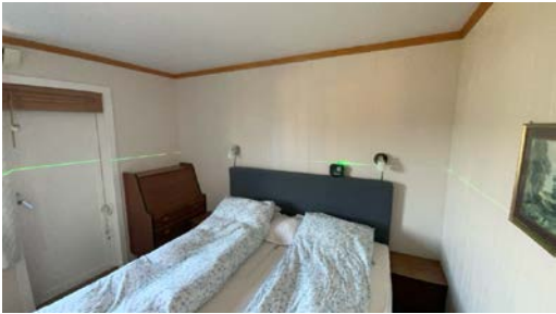
1. etasje Plassering av laser ved kontroll av soverom 2. Det er målt 20 mm høydeforskjell gjennom rommet. TG 2. Over en avstand på 2 meter er det målt 20 mm fra verandadør til garderobeskap. TG 2
