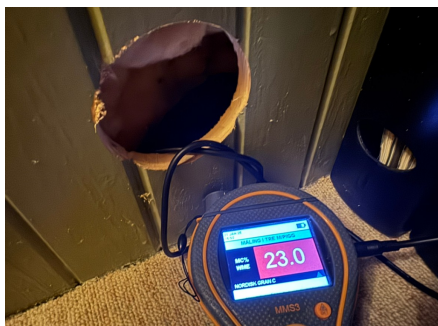
Fuktmålingen viser 23 vektprosent.
