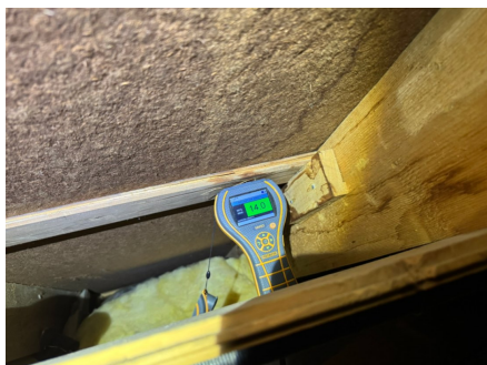
Fuktmåling i kubbing.
