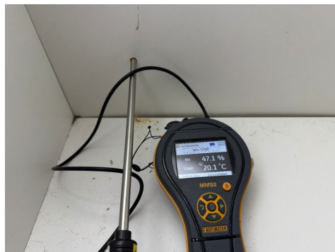
Måling av relativ luftfuktighet.
