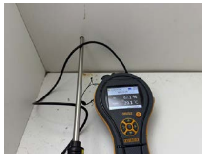
Måling av relativ luftfuktighet.
