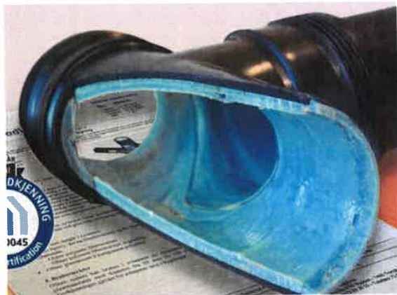
Eksempelbilde på rør rehabilitert avløpsrør.
