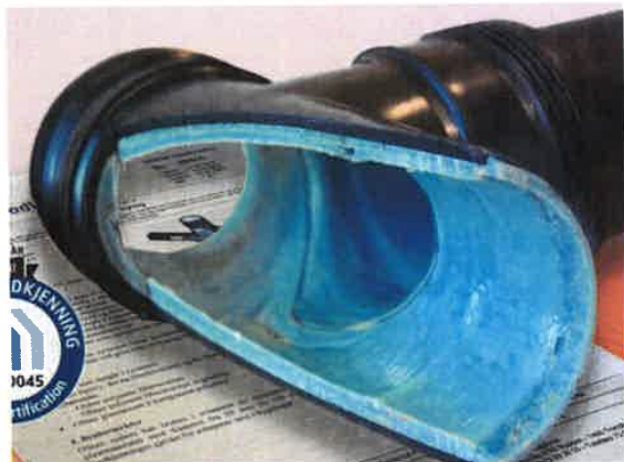
Eksempelbilde på rør rehabilitert avløpsrør.
