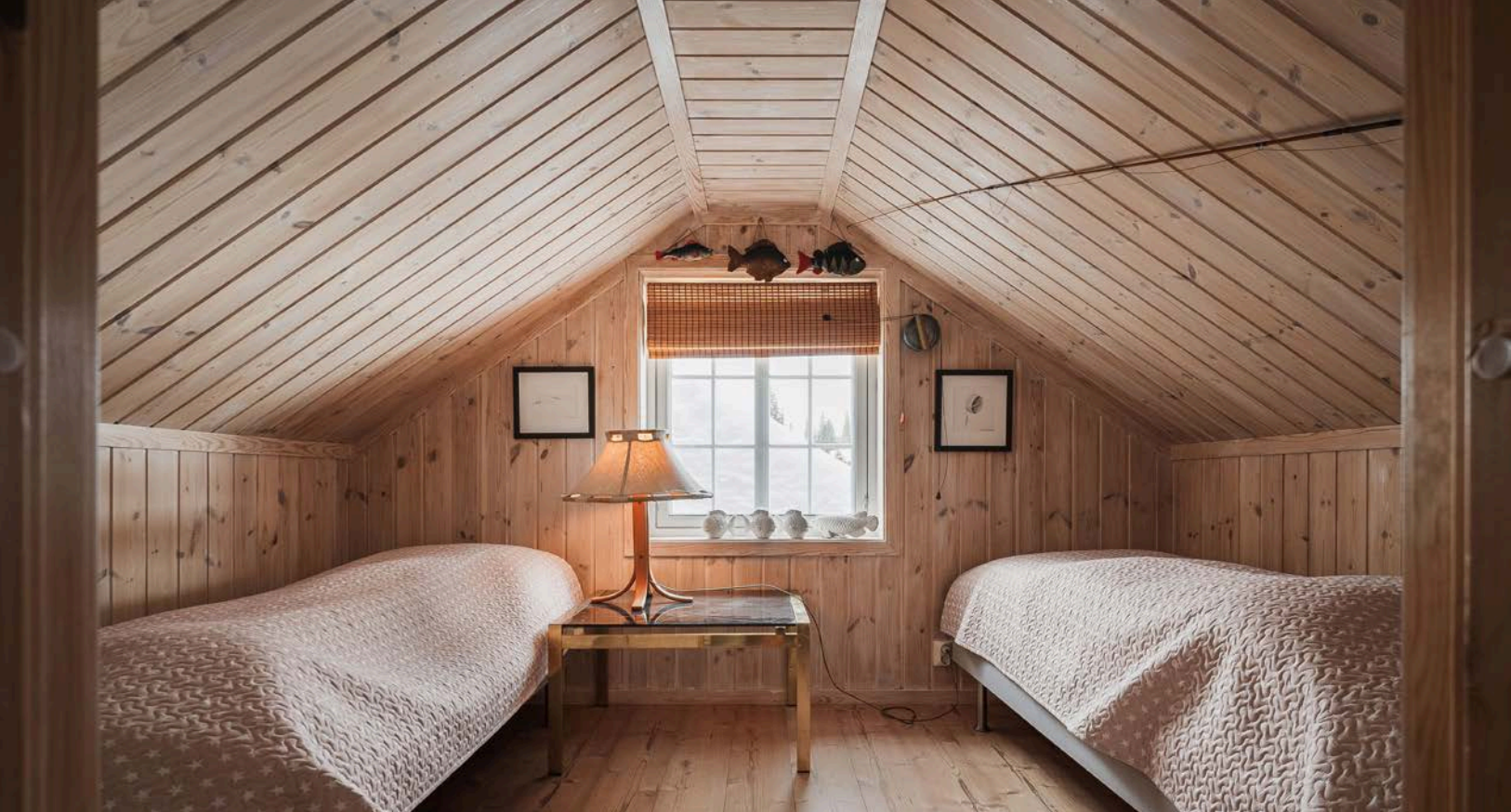
Det nord-vestre rommet i loftsetasjen, som er innredet med to enkeltsenger. Rommet er ikke måleverdig pga. lav himlingshøyde, og det er ikke godkjent for varig opphold.
