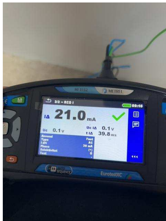
Skjema: "NELFO Per. kontr. Bolig NEK405-2" Spørsmål: Måling/prøving Beskrivelse: Jordfeil bryter, Filnavn: img_0001.jpg
