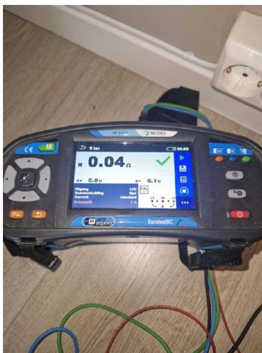
Skjema: "NELFO Per. kontr. Bolig NEK405-2" Spørsmål: Kontinuitet i jordledninger og utjevninger Beskrivelse: Etter utbygging, Filnavn: IMG_20240425_084738.jpg
