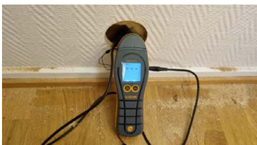
Hulltaking ble foretatt, ingen forhøyde verdier ble registrert i denne delen av vegg.
