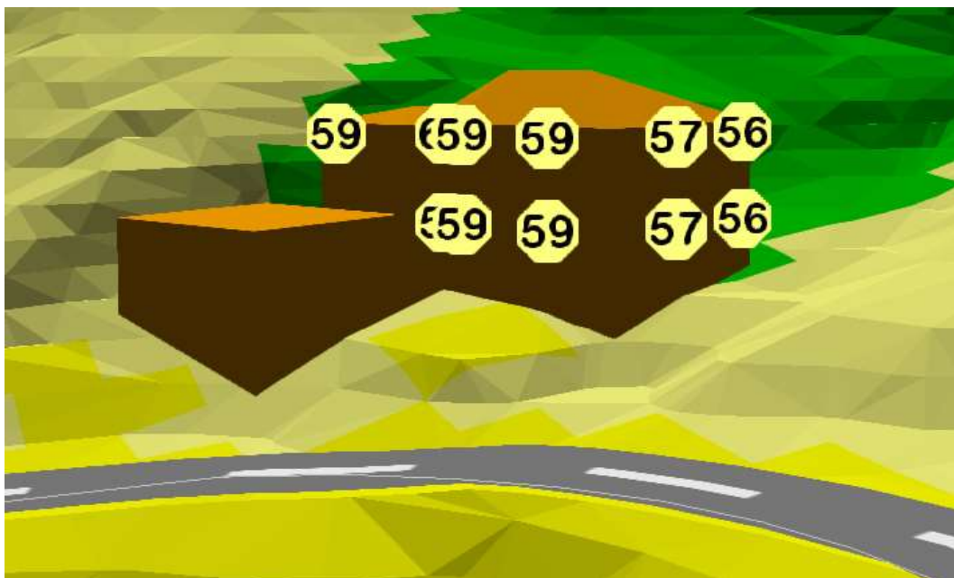
Figur 4-1: Fasadenivåer bolig fra 3D-modell. L_{den} er brukt som beregningsparameter. Sett fra nordøst.
