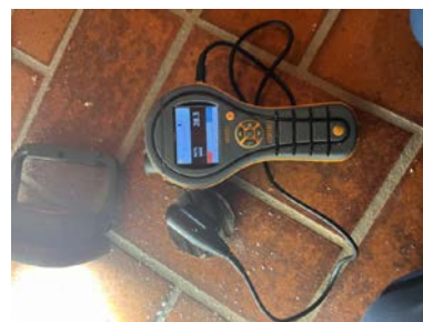
Målt på bakside av panel i vegg mot grunnmur.
