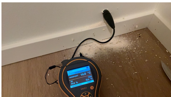
Måling av relativ luftfuktighet i utlektet veggkonstruksjon fra bod i kjeller.
