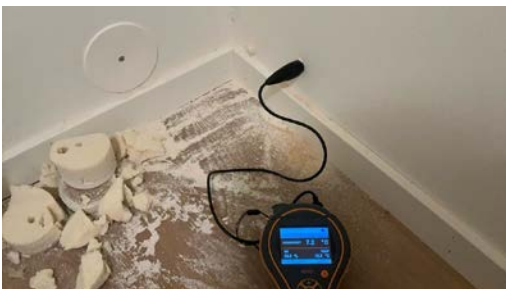
Måling av relativ luftfuktighet i lukket veggkonstruksjon mellom tilliggende bod og våtsone
