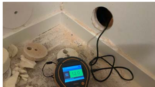
Måling av trefukt i lukket veggkonstruksjon mellom tilliggende bod og våtsone.
