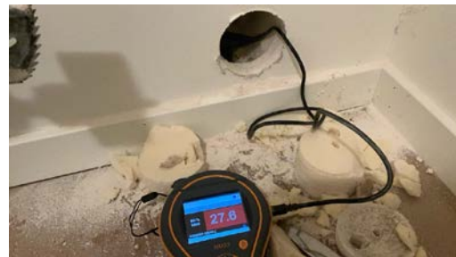
Måling av trefukt i utlekket veggkonstruksjon fra bod i kjeller.
