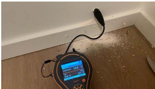
Måling av relativ luftfuktighet i utlekket veggkonstruksjon fra bod i kjeller.
