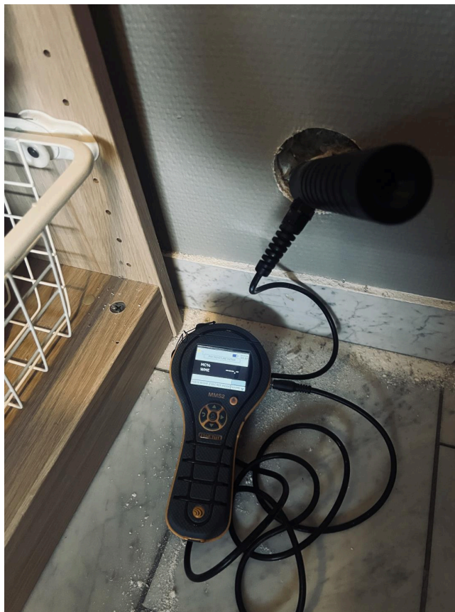
Fuktmåling bad 1. etg.
