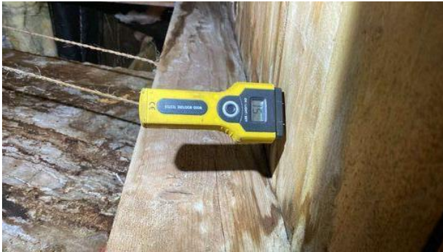
Ingen forhøyede fuktverdier på befaringssdag i rupanel ved rennmerker ved pipe.
