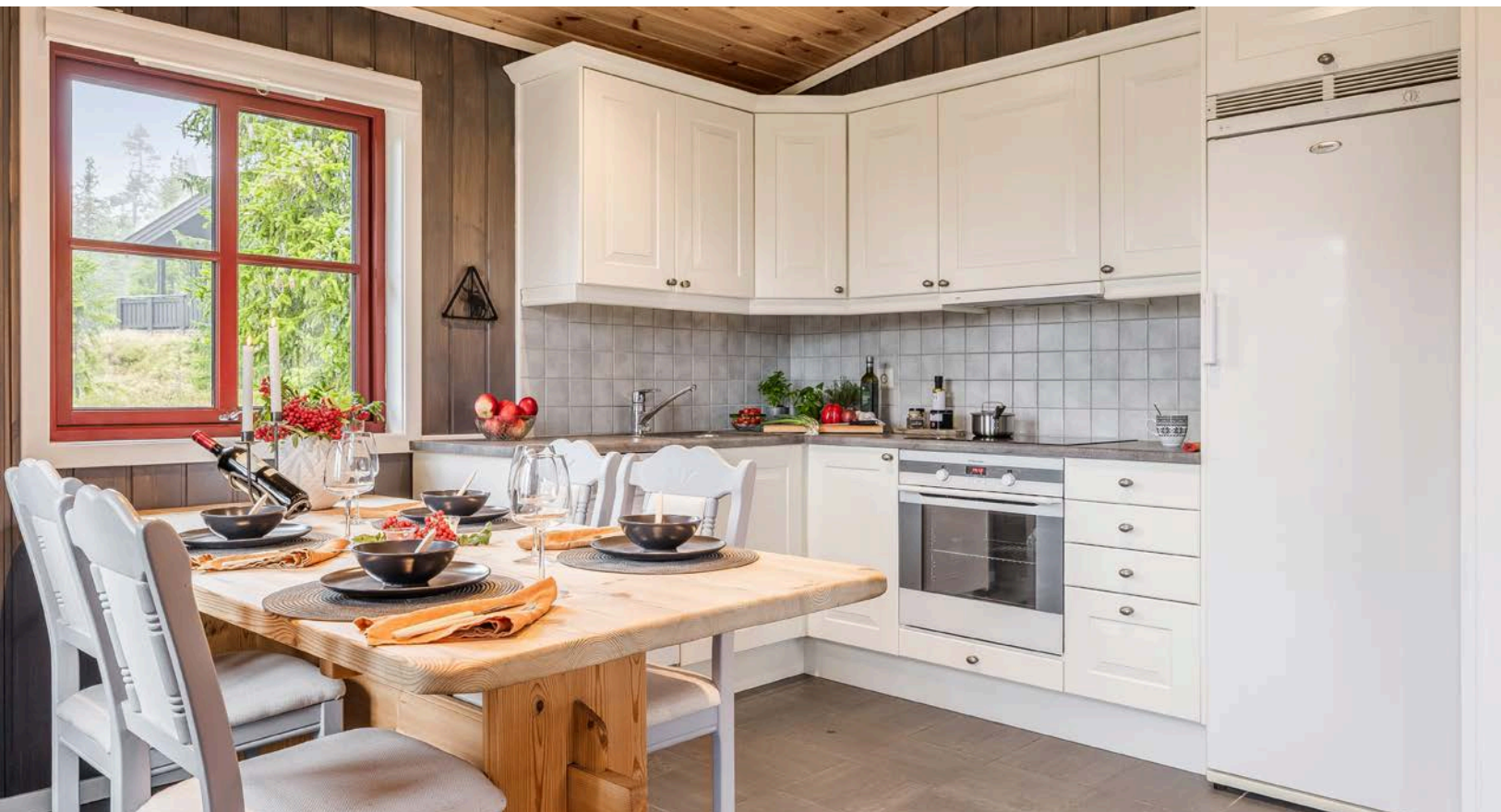
Lys og pen kjøkkeninnredning fra 2007 med god skap- og benkeplass. Innredningen har lyse profilerte fronter, laminert benkeplate med nedfelt oppvaskkum og fliser i benkeryggen.
