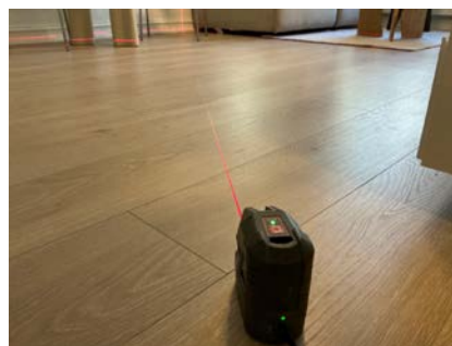
Nivellering stue/kjøkken + soverom, avvik ca. 10-20 mm
