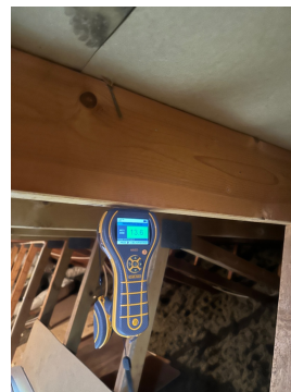
Fuktmåling i takstol viser tørre verdier
