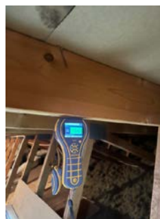
Fuktmåling i takstol viser tørre verdier
