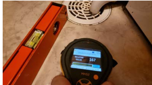
Fuktmåling i gulvet, ingen unormale fuktverdier ble registrert
