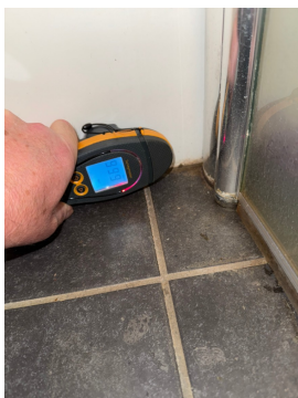
Riss i fuger og indikasjon på fukt bak fliser
