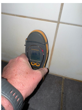
Riss i fuger og indikasjon på fukt bak fliser
