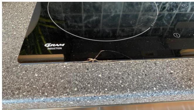
Sprekker i platetopp.
