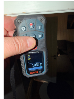
Meget lav frihøyde ved trapp til kjeller, kun 1,43m. Kravet er 2,00m.
