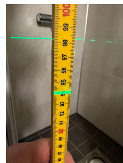
Flis inni dusjhjørne 94,3cm. Motfall til sluk på 4mm.
