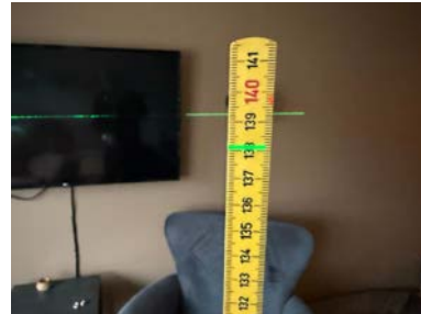
Stue 138,2cm. Lokalt avvik på ca. 22mm målt i en lengde på 2m.
