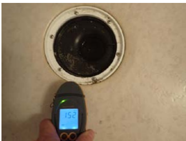
Ingen symptomer på skadelig fukt i kontrollert sted.
