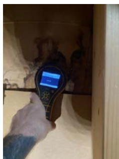
Fuktmåling i takkonstruksjon viste ingen forhøyede fuktverdier (takkonstruksjon mot nord.)
