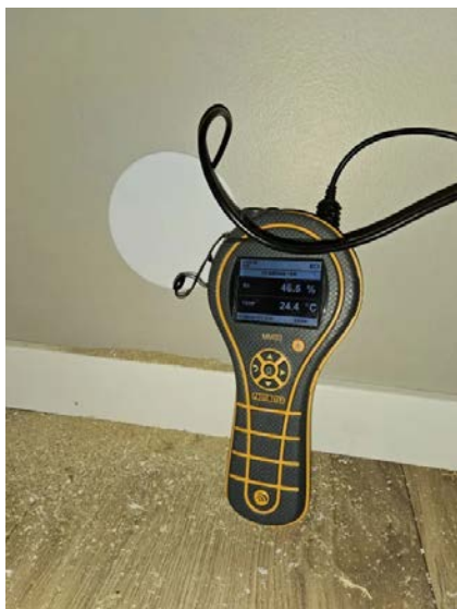
Bilde viser fuktmåling.
