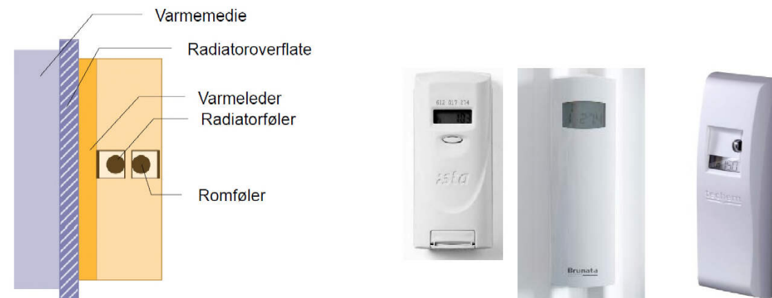
Figur 4 Prinsipp for radiatormåling (t.v.) (kilde: Ista) og eksempler på radiatormålere fra Ista, Brunata/Minol og Techem (t.h.)
