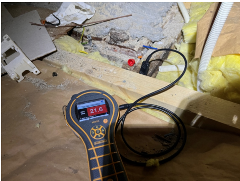
Fuktmåling i bjelker rundt skorstein.
