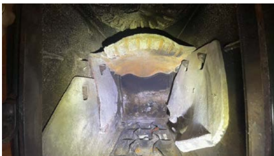
Skadede brannplater i ovn
