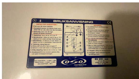
Spekk på varmtvannstank.
