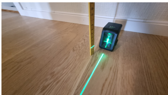
Kontroll av planavvik.
