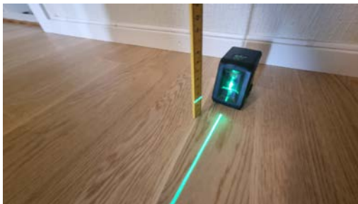
Kontroll av planavvik.
