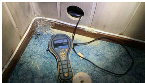
Fuktmåling ble foretatt, jeg målte tørre verdier i konstruksjon.
