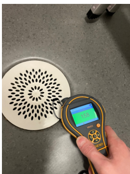
Det er gjort overflatesøk med håndholdt fuktmåler uten målt avvik i forhold til referansenivå i rommet (tørr sone)
