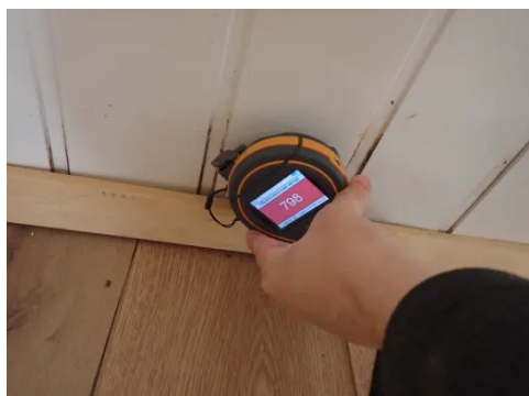
Fuktmåling på utforet vegg i tilbygg.
