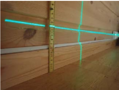
Referansenivå laser = 40 mm. Viser skjevheter på ca. 70 mm over 2,4 meters lengde.
