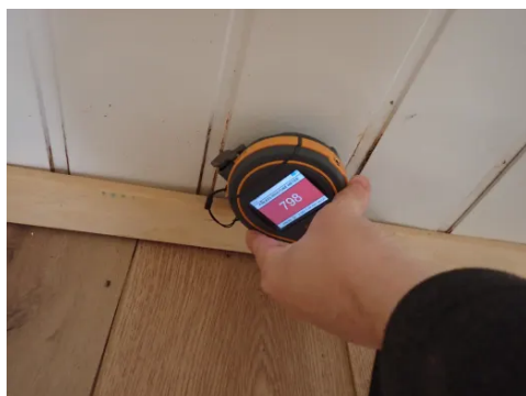
Fuktmåling på utforet vegg i tilbygg.
