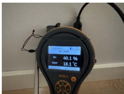
Måling av relativ luftfuktighet.
