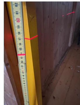
Høyde 54 cm, planavvik på gulv er 80 mm
