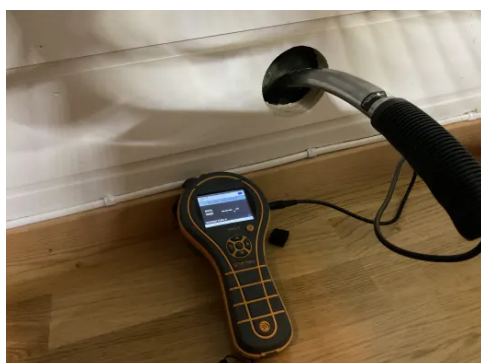
Hulltaking i tilstøtende rom.
