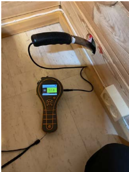
Fuktmåling i vegg mot terreng.
