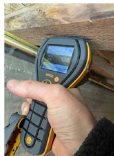
Ved stikkprøver måles det 17 vektprosent fukt.
